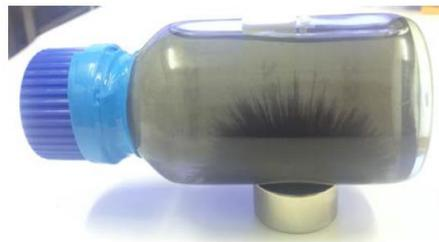
鉄粉が整列している向きに磁石の磁力が働いていることを観察できる。
