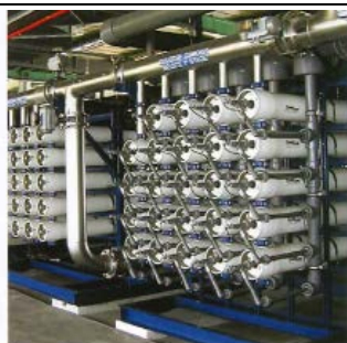
特殊な膜で分離する方法を使った海水淡水化プラント（シンガポール）
