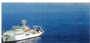
④ 海底ケーブルの設置（千葉県、南房総市沖、2013年撮影） 海底ケーブルはテレビ放送やインターネット通信だけでなく、海底で起こる地震の観測にも利用されています。
