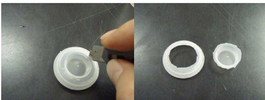
フィルムケースは、ふたに加工をします。カッターナイフを使って、外枠を残して、円状に切り抜きます。この穴を通して水が取り込まれます。
