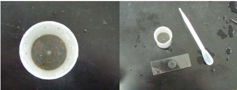
ふたを外し、スポイトで少量とって穴明きスライドガラスに移します。多すぎるとこぼれますので注意させます。
