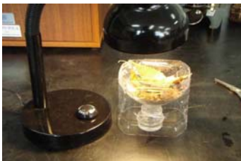
ツルグレン装置（上部から光を当て、生物を追い落とす仕組み）
