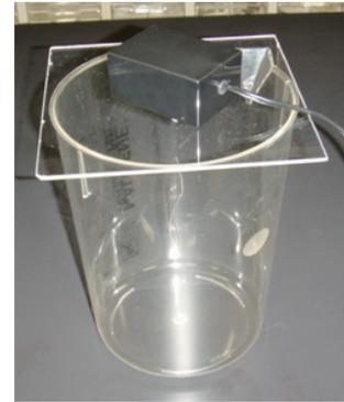
注) 水替えなどでモーターを止めてビーカーから外すときに、羽根をつけたままモーターを裏返しにしないでください。羽根から軸を伝って海水がモーターに入り、モーターがダメになります。羽根を付けたまま置きたいときは、横向きにしてください。
