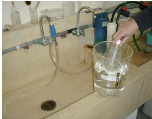
水流ポンプからの、水を吸引する管に取り付けたピペットを、ペットボトルの中に入れ、海水を吸い出します。
