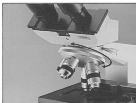
レボルバーを回して、使用する対物レンズを交換する。レボルバーはクリック位置でしっかり止める。このとき、真下を向いているレンズが使用できる（観察光路に入っている）ことになる。レンズの交換には必ずレボルバーを回すこと。レンズを持って動かすと、光軸がずれてしまう可能性があるので注意。
